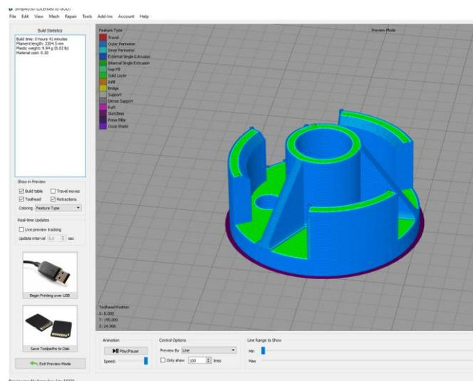
Gambar 3. Proses Simulasi 3D *Print* dengan Simplify3D
