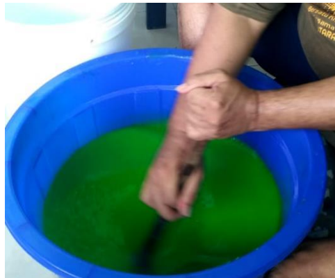
Gambar 2. Proses pengadukan sabun cair secara manual
