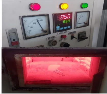
Gambar 2. Pemanasan Benda Uji Sampai Suhu Kritis
