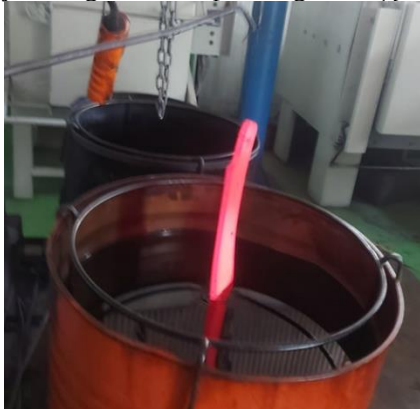
Gambar 3. Pendinginan Benda Uji ke Dalam Media Oli
