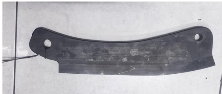
Gambar 4. Benda Uji Setelah Mengalami Proses Pengerasan
